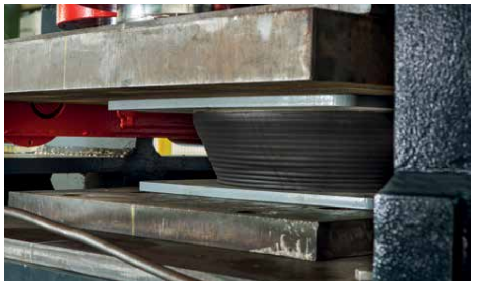
Prueba de rigidez horizontal en apoyo de caucho
