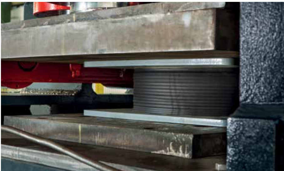
Prueba de rigidez horizontal en apoyo de caucho
